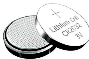
Figur 6. Døme på to knappcellebatteri: CR2032 litiumbatteri. Den positive polen er markert. Diameter: 20 mm Tjukn: 3,2 mm Spenning: 3 V Batterikapasitet: 200 mAh
